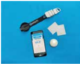
Mynd 1. MOTI kemur með ól sem hægt er að spenna um höfuð eða útlimaliði og þannig mæla hreyfingar. Einnig er hægt að líma hann fastan ef þess þarf.
